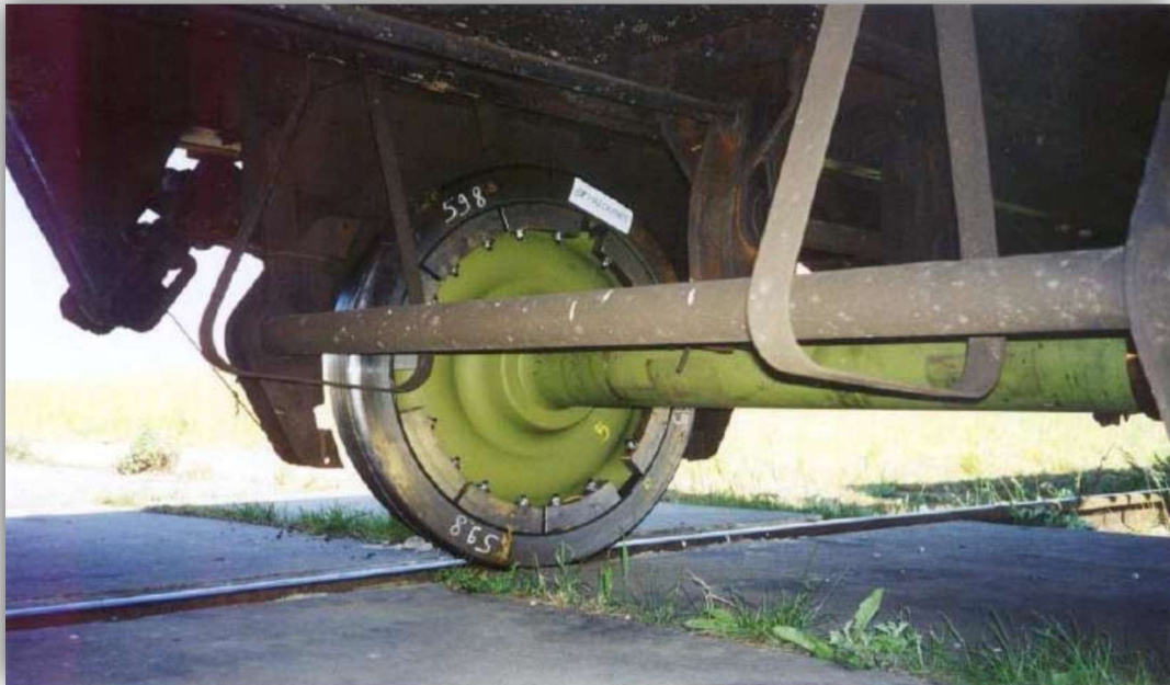
Rysunek 30. Przykładowe zastosowanie amortyzatorów kół (źródło: Hemsworth 2006)
