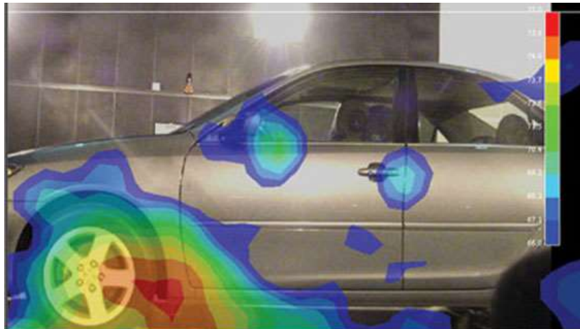
Rysunek 14. Mapa akustyczna samochodu (źródło: http://edroga.pl/images/stories/n_badania/badania-halaslivosti-opon-samochodowych-i-zrodla-halasu-w-pojazdach-samochodowych/r3.jpg )
