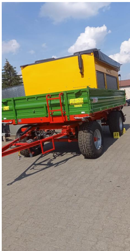
Zdjęcie 31. Remonter drogowy typu Patcher
